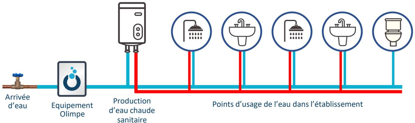
L'équipement Olimpe transforme les sels minéraux présents dans l'eau en chlore actif lors du passage de celle-ci dans sa cellule d'électrolyse. **L'eau est non seulement sécurisée bactériologiquement, mais elle acquiert des propriétés désinfectantes naturelles** qui vont **détruire le biofilm dans les canalisations, prévenant ainsi les risques de recontamination** au sein du réseau.
